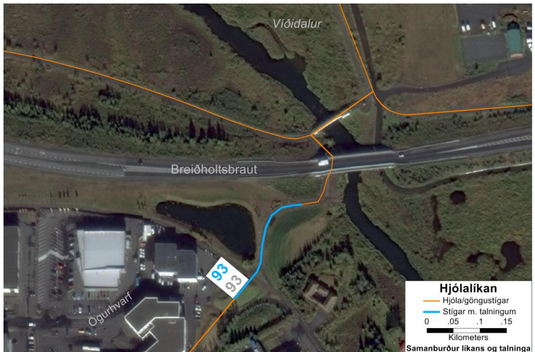
Mynd 6.16 Talningastaður við Breiðholtsbraut, á göngustíg frá Dimmuvarfi. Bláa talan er talning en gráa talan er niðurstaða líkans. Stígar með talningum eru bláir en aðrir stígar líkansins eru gulir. (loftmynd Google Maps)
